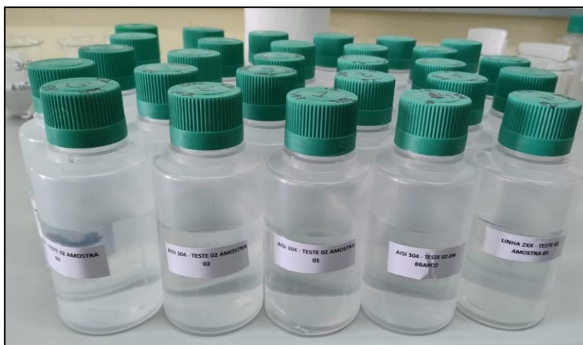
Figura 18 – Frascos contendo as soluções após os ensaios, preparados para análise de absorção atômica
