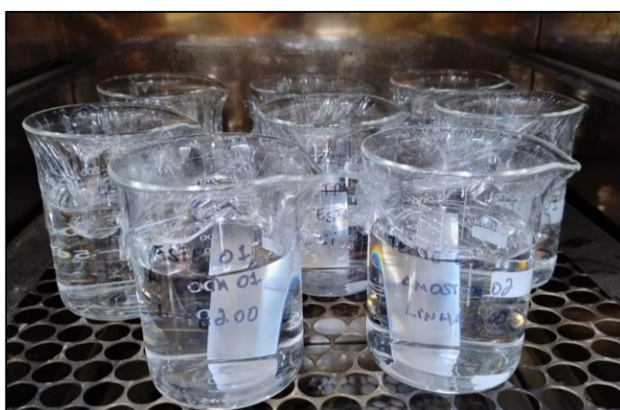
Figura 15 – Recipientes com amostras na estufa de laboratório a 40°C por 10 dias
