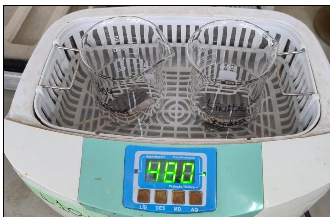
Figura 13 – Limpeza das amostras em banho ultrassônico utilizando acetona
