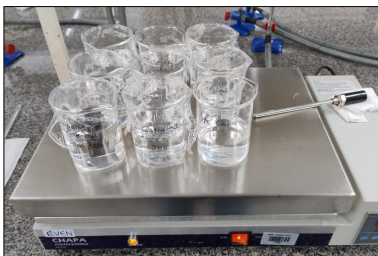
Figura 16 – Recipientes com amostras na chapa aquecedora (foram mantidas por duas horas e depois postas em um forno a 40°C por 24 horas)
