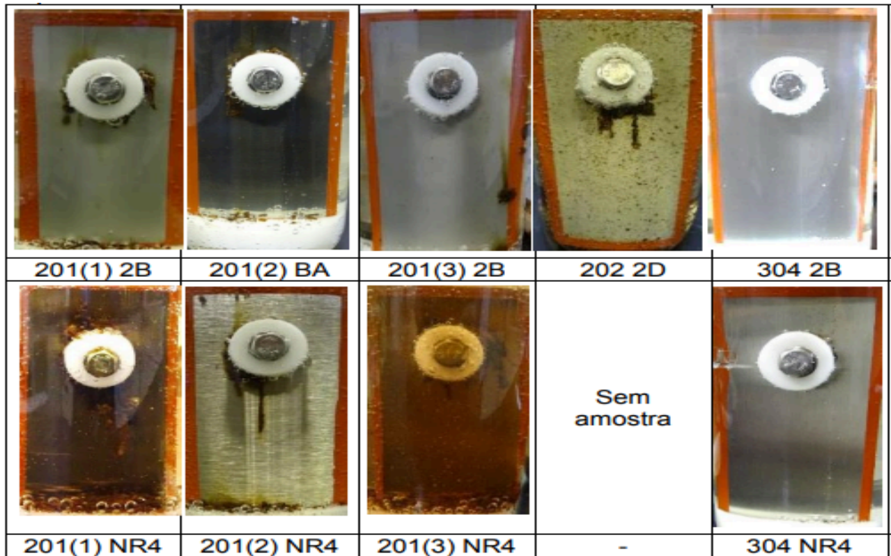
Figura 4 – Aspecto dos corpos de prova dos diferentes aços dentro da solução de hipoclorito de sódio a 2,5 % após 1 dia de ensaio
