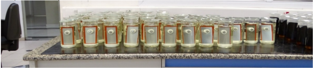
Figura 3 – Aspecto do ensaio de imersão em solução de hipoclorito de sódio a 2,5 %. Verifica-se que a solução de hipoclorito é transparente e levemente amarelada
