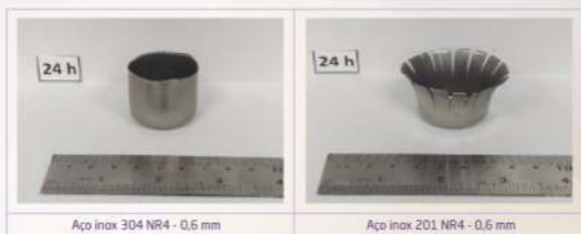
Figura 03 - Ensaio de Swift após 24 horas.
