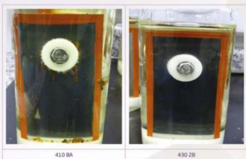
Após os 13 dias de ensaios podemos ver como o meio é agressivo a ambas as ligas, porém o 430 demonstra maior resistência e um aspecto menos corroído. Note que além da corrosão esperada nas frestas geradas artificialmente para acelerar o ensaio, a corrosão em toda a face do corpo de prova é acentuada no 410.
