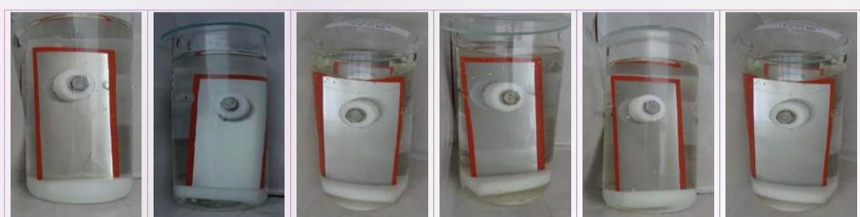
Figura 1 - Aspecto dos frascos no ensaio de imersão em suor sintético
