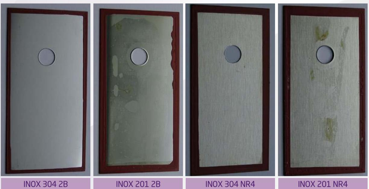
Figura 2 - Comparativo de Resistência à corrosão das amostras de 304 x "201" nos acabamentos brilhantes e lixados.
