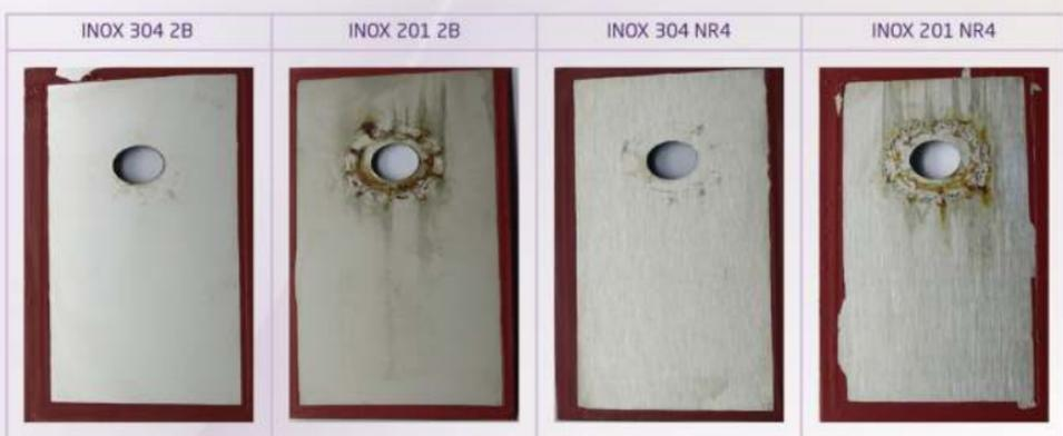
Figura 1 - Comparativo de Resistência à corrosão das amostras de inox 304 x inox 201.
