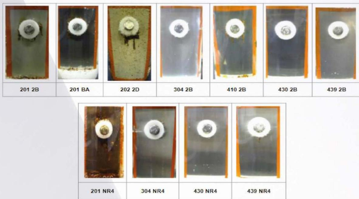
Tabela 3 - Aspecto dos corpos de prova dos diferentes aços dentro da solução de água sanitária (hipoclorito de sódio a 2,5 %) após 1 dia de ensaio.
