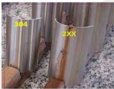
Figura 2 - Condição superficial de contorno de solda de tubos 304 x Série 200 após 1000h de névoa salina.
