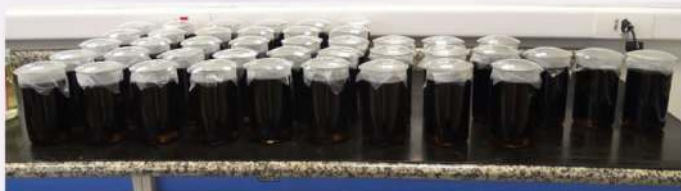
Figura 1 - Disposição das amostras na imersão/ contato em molho de tomate
