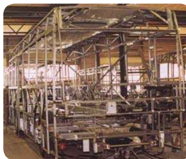
Estrutura da carrocça de um ônibus em aço inoxidável 430, África do Sul
