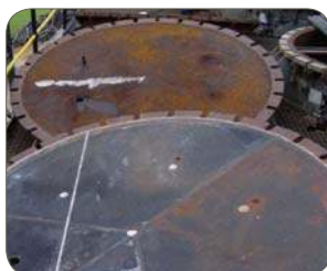
Tipo 1.4003/410, Columbus, África do Sul. Aço carbono (no alto) comparado ao ferrítico (abaixo) após 6 anos de uso
