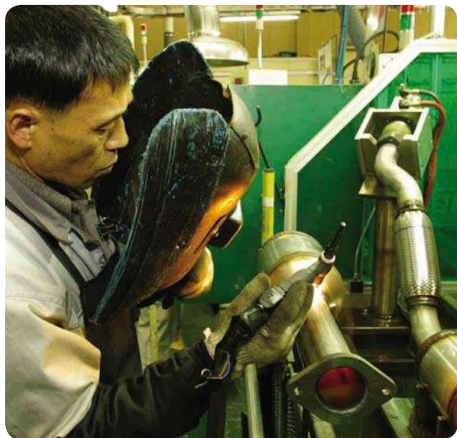
Soldagem sistema de escapamento, tipo 439, Korea.
