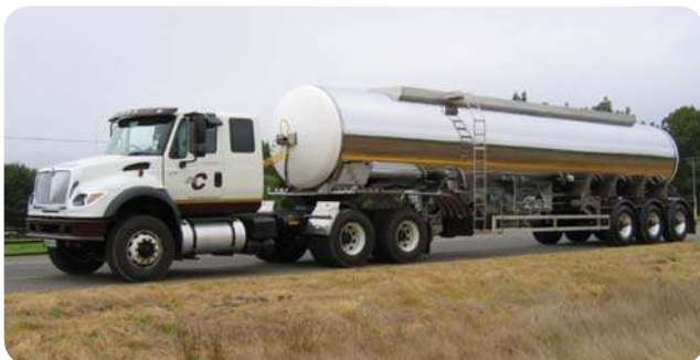
Caminhão tanque com feitor, revestimento com tipo 430, África do Sul.
