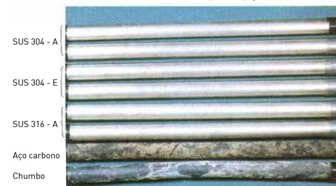
2. Cidade de Kuwana, teste No. P; após decapagem com ácido
