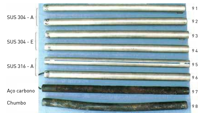
1. Cidade de Kushiro, teste No. H; após decapagem com ácido
