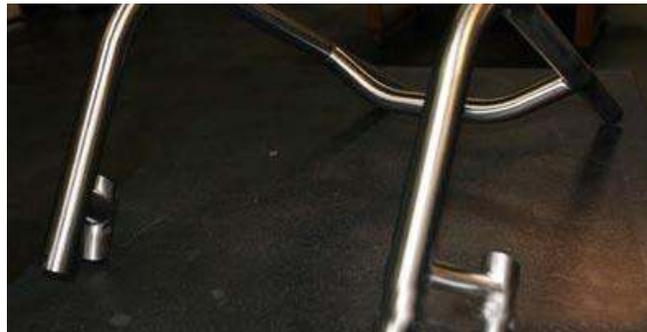
*Aços inoxidáveis de alta resistência tais como os austeníticos endurecidos ou os duplex, podem ser utilizados com menor espessura e, conseqüentemente, reduzir o peso dos componentes estruturais das cadeiras de rodas.*
