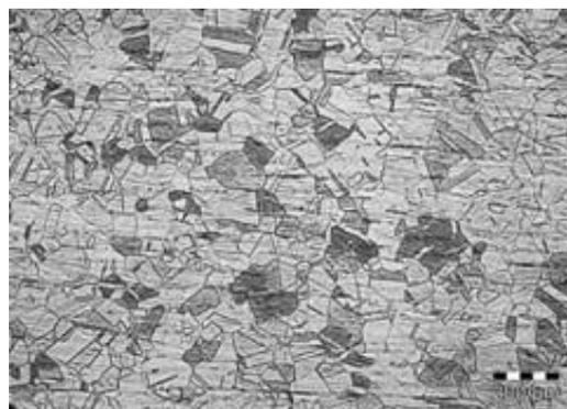
Foto 2 – Estrutura ferrítica – aço inox tipo 430
