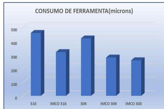
Pela sua elaboração e comportamento em uso, estes aços conciliam um bom desempenho em usinagem sem prejuízo da resistência à corrosão do aço original. Além disso, o aço mantém a mesma especificação de composição química e propriedades mecânicas exigidas pelas normas internacionais AISI, SAE, ASTM, ASME, Norsok, NACE, típicas da exigência pela qualidade na indústria brasileira de manufatura, principalmente nos casos de aplicação final em óleo e gás, química e petroquímica.
