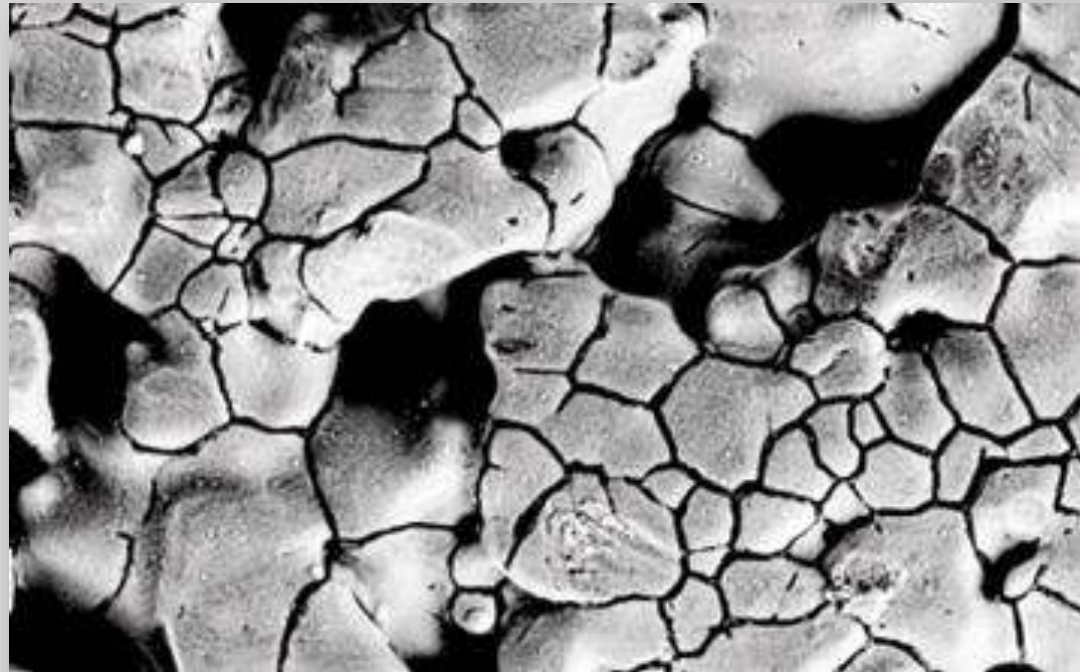
Imagem de Microscopia Eletrônica de Varredura Corrosão Intergranular em AISI 304 Ácido Sulfúrico - solução aerada 0,5M
