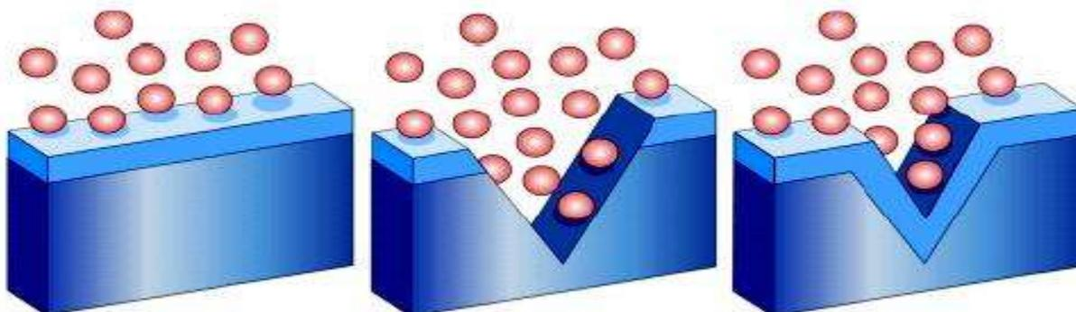
*Figura 1* – Num ambiente oxidante normal uma camada protetora de um filme passivo de óxido rico em cromo é formado automaticamente no aço inoxidável.
