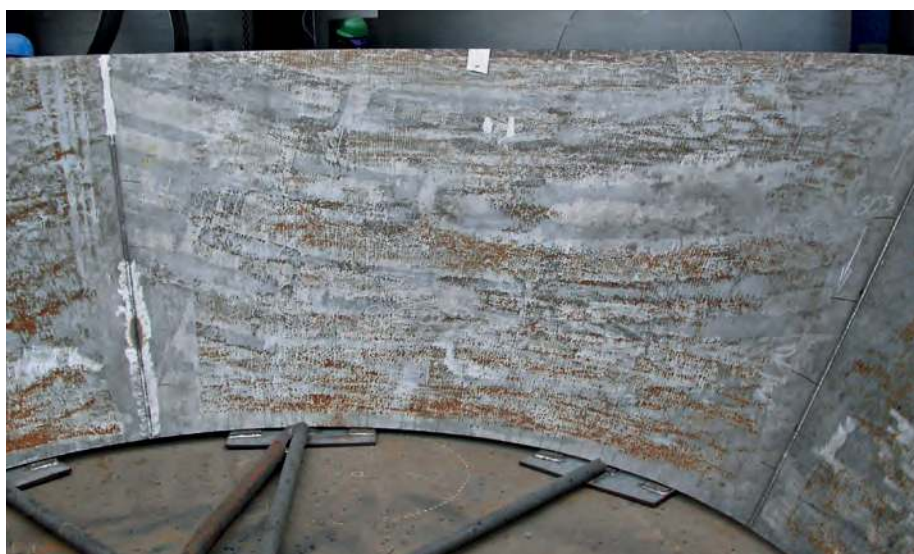
Ferro incrustado em trabalho com placa de aço inoxidável duplex laminada. © Gary Carinci, TMR Stainless
