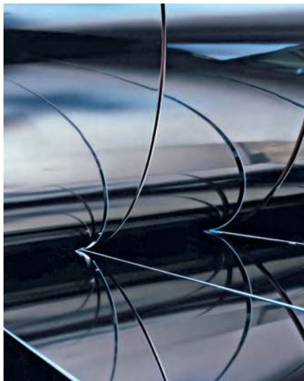
Corte de tiras de aço inoxidável duplex. © Outokumpu
