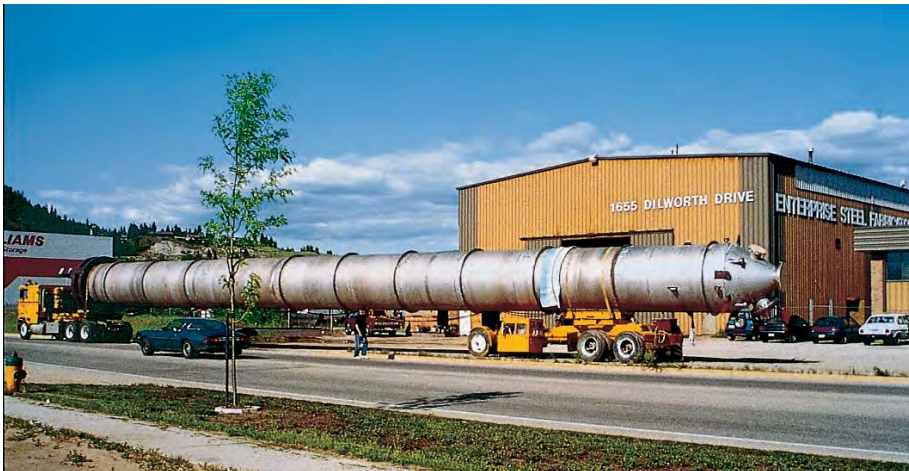
Reator de deslignificação com oxigênio fabricado com 2205, Enterprise Steel Fab, Kalowna, Prince George, British Columbia, Canadá. © Outokumpu
