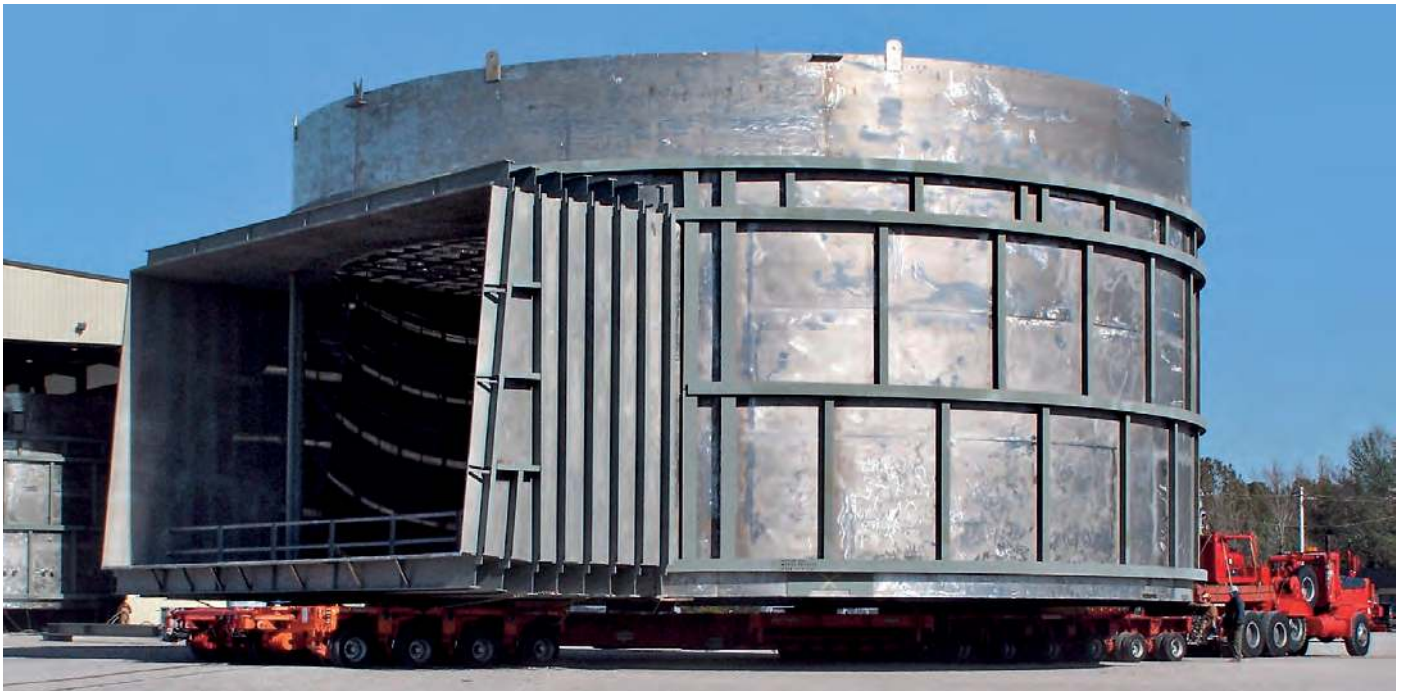
Unidade de dessulfurização de gases de combustão, fabricada com aço inoxidável 2205. © ArcelorMittal
