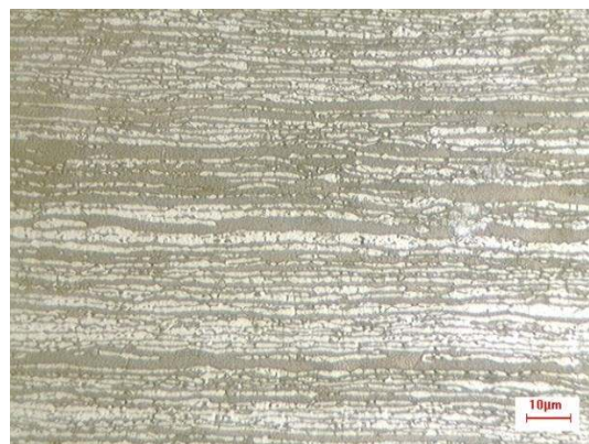
Figura 1 – Micrografia do aço UNS S32304, 1000X; reativo Behara II.
