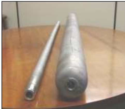
Figura 4: A foto mostra o aspecto das amostras com costura após o teste.
