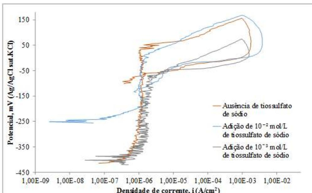
**Figura 1.** Curvas de polarização potenciodinâmica cíclica obtidas para o aço supermartensítico com cerca de 14% de cromo em soluções desaeradas contendo 115.000 ppm de cloreto, 0,4 g/L de acetato de sódio tri-hidratado, com e sem adição de tiosulfato de sódio.
