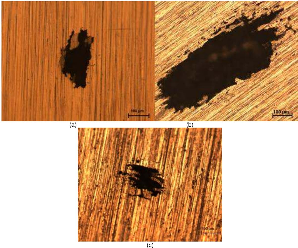
**Figura 5.** Morfologia do aço supermartensítico com cerca de 14% de cromo após ensaio em meios (a) sem adição de tiosulfato, (b) com adição de  $10^{-2}$  mol/L de tiosulfato de sódio, (c) com adição de  $10^{-3}$  mol/L de tiosulfato de sódio.
