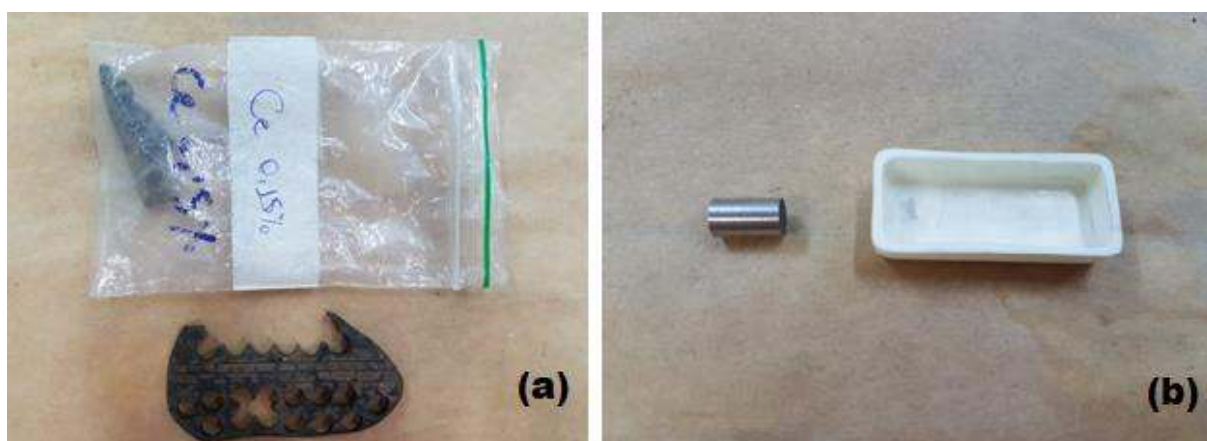
Figura 1 – (a) Chapa da liga com 0,15%Ce usinada para remoção das amostras cilíndricas, (b) Conjunto amostra e cadinho para a oxidação.
