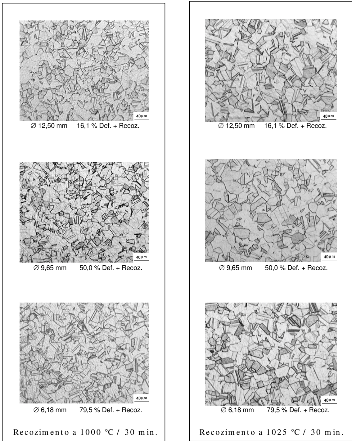
Figura 7 - Microestruturas da secção longitudinal na região entre a superfície e o meio-raio dos fios nas condições trefilados + recozidos a 1000 °C e 1025 °C / 30 min. Fios com deformações antes do recozimento de 16,1%; 50,0%; 79,5%. Ataque eletrolítico com solução de ácido oxálico a 10%.
