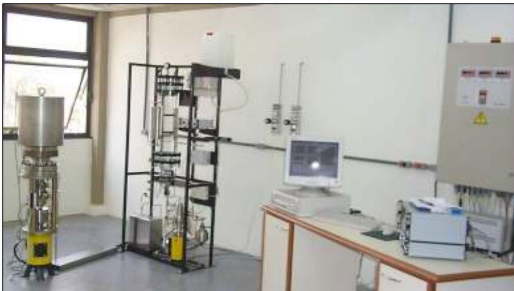
Figura 1. Instalação para ensaios de corrosão sob tensão.
