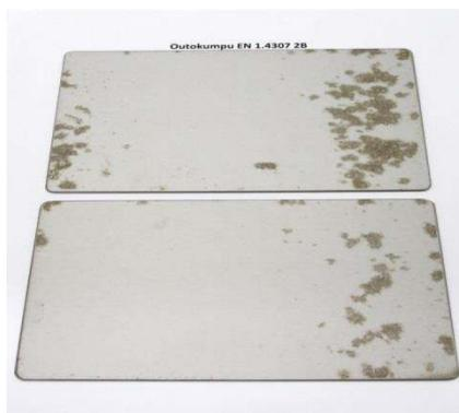
**Figura 3** – Amostras de 304L após ensaio em névoa salina
