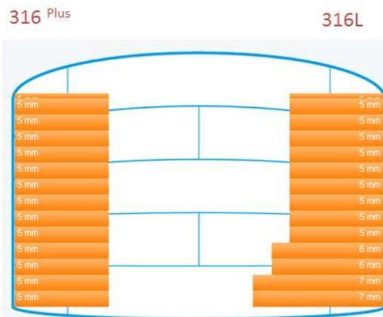
Figura 6 – Dois exemplos de tanques fabricados com 316<sup>plus</sup> e 316
