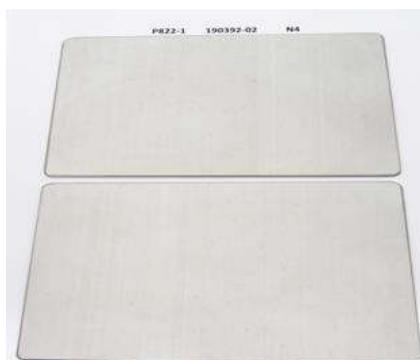
**Figura 1** – Amostras de 4622 antes do ensaio em névoa salina
