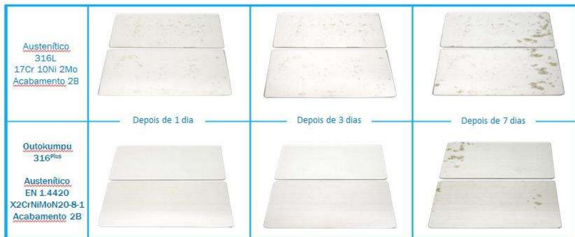
Figura 5 – Ensaios de névoa salina do 316<sup>plus</sup> e 316L
