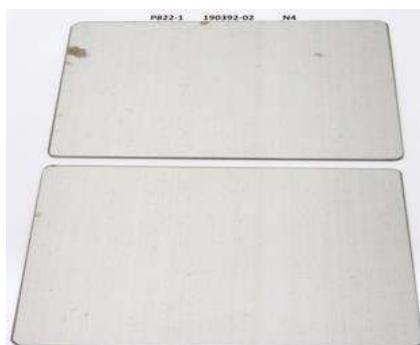
**Figura 2** – Amostras de 4622 após ensaio em névoa salina
