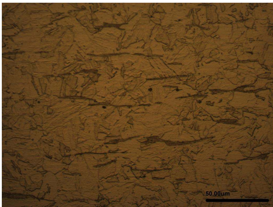
Figura 1. Aço SM2MoNb tal como recebido. Ataque com reagente Vilella. Nota-se a presença de ilhas de ferrita delta.
